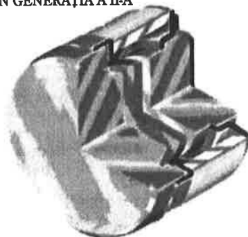
Figura 3: Intensificator de imagine din generația a II-a, secționat
