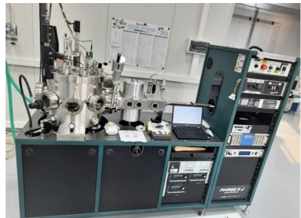
Fig.4 Système de pulvérisation cathodique en champ magnétron assistée par radiofréquence AJA Phase II J
