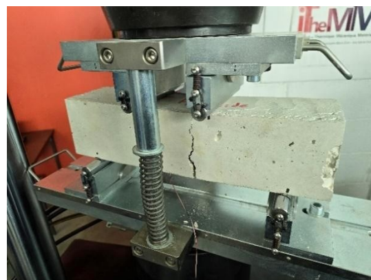
Fig. 2 : Essai de flexion sur l'éprouvette prismatique en béton
