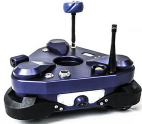
Fig. 6. TRIC (scanner à chenilles d'inspection à trois roues) installé dans le drone AeroX [12]
