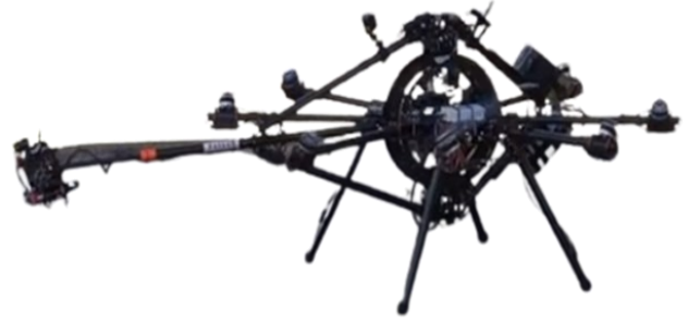
Fig. 5. Drone AeroX, avec manipulateur [12]
