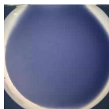
Fig. 6. Distribution spatiale des RONS obtenue en exposant des matrices KI-amidon au plasma pendant 60 secondes.
