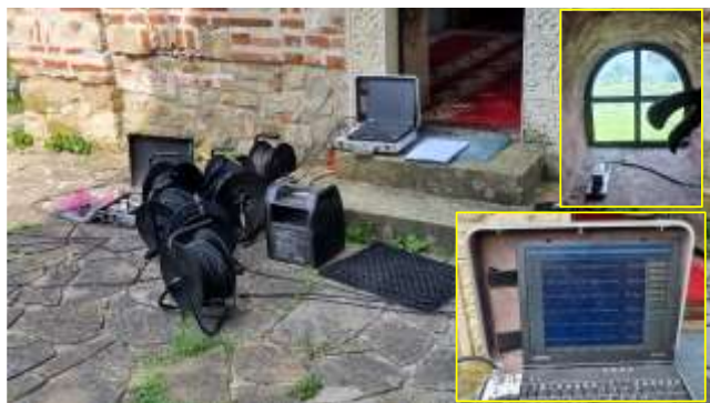
Fig. 3. Équipements pour la mesure de vibrations ambiantes.
