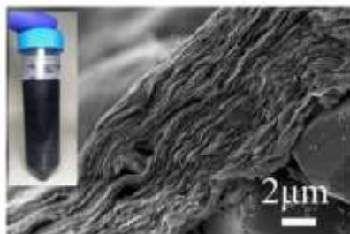
Figure 4. Micrographie MEB transversale typique d'un FF du TCO, avec image en médaillon d'une suspension colloïdale typique.
