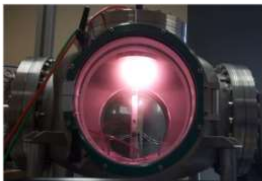
Fig. 1. Plasma dans un réacteur basse pression (volume 40 litres)
