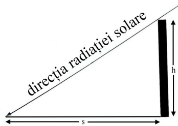
Fig. 1.4: Calculul masei de aer utilizând umbra unui obiect de înălțime dată
