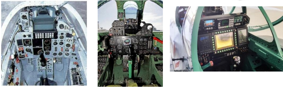
Fig. 2. Cabine IAR-93 modernizare propusă 1992 reprezentând faza 1, J-22 Orao implementată din producție, cabina ORAO 2.0, modernizare radicală
