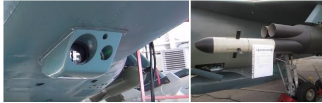
Fig. 3. ORAO 2.0 Turela ventrala optoelectronică low cost pentru sectorul frontal, rachetă ghidată laser
